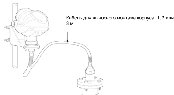
Рисунок А-15. Выносной монтаж корпуса
