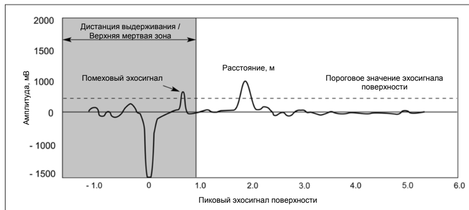
Рисунок С-4. Определение Hold Off Distance/UNZ (Дистанция выдерживания / Верхняя мертвая зона) на графике эхосигнала
