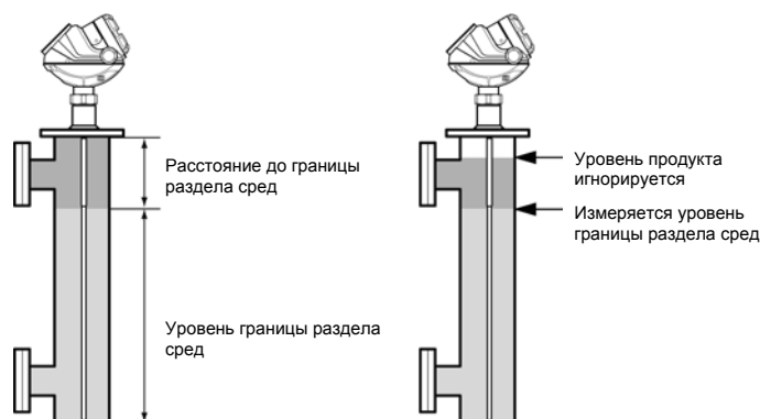
Рисунок 7-12. Измерение уровня границы раздела сред в заполненной камере
