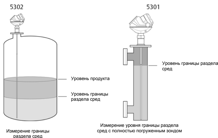
Рисунок А-8. Измерение уровня границы раздела сред с полностью погруженным зондом
