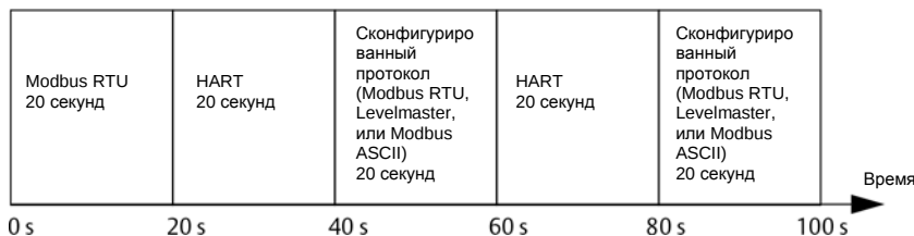
Рисунок J-8. Обмен данными по шине RS-485 после запуска
