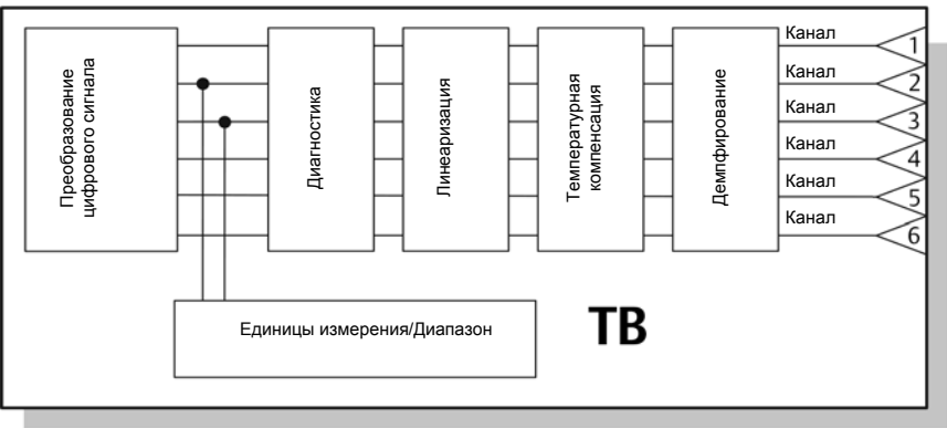
Рисунок Е-1. Блок-схема преобразователя
